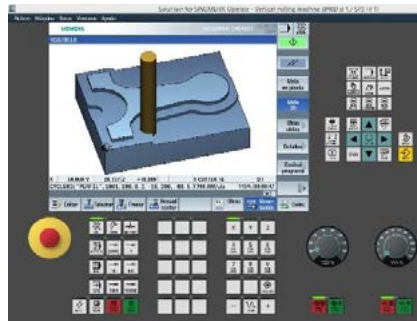
Figura 8. Postura y mecanizado de pie de biela en lenguaje Sinumerik 840D (Siemens).
